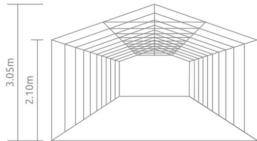
Estrutura em Tubo galvanizado 54X1.4mm
