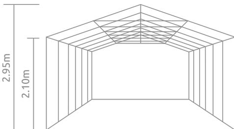
Estrutura em Tubo galvanizado 38X1.2mm
