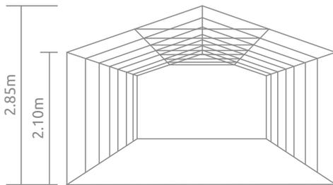
Estrutura em Tubo galvanizado 38X1.2mm
